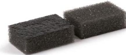
**PU-Folie** ist eine Polymer-Oberflächenbehandlung, die direkt auf ausgewählte Materialien aufgetragen wird. Sie verleiht eine strukturierte, ästhetisch ansprechende Oberfläche und verbessert die Schallabsorption. Die PU-Folie bietet eine Barriere gegen Feuchtigkeit, Schmutz, Fett und Chemikalien und macht die Oberfläche nach der Vermietung der Geräte reinigungsfähig. Sie erreicht eine gleichwertige akustische Leistung wie andere Materialien, ist aber weniger dick.
